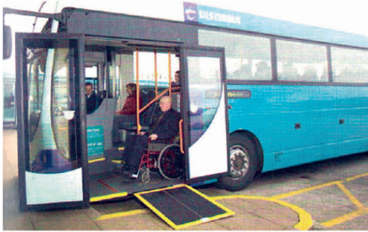
Fotoğraf 3.2. Taşınabilir rampa, tutamak ve kendisine ayrılan yerde bir tekerlekli sandalyeli (ÖZİDA, 2008)
