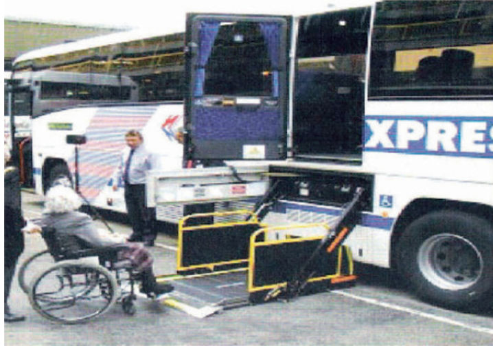
Fotoğraf 3.3. Kaldıraç aracılığıyla yüksek tabanlı yolcu otobüsüne erişim (ÖZİDA, 2008)
