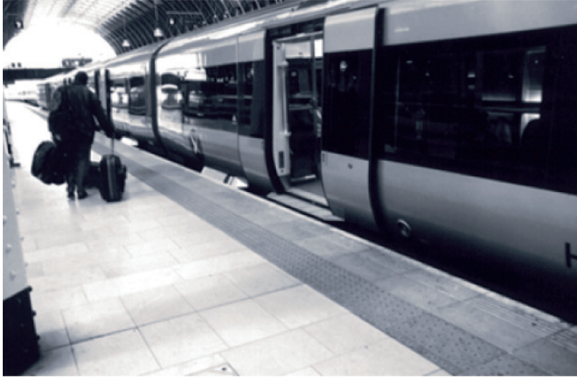
Fotoğraf 3.7. Peronda uyarıcı ögenin düzenlenmesi örneđi (Naniopoulos, 1999)
