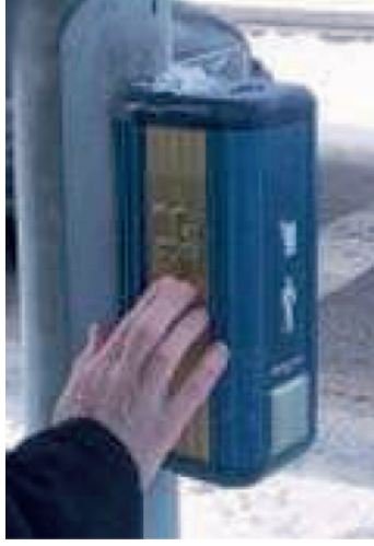
Fotoğraf 3.11. Braille alfabeli, dokunarak işletilen sesli uyarıcı (DfT, TScot, 2008)
