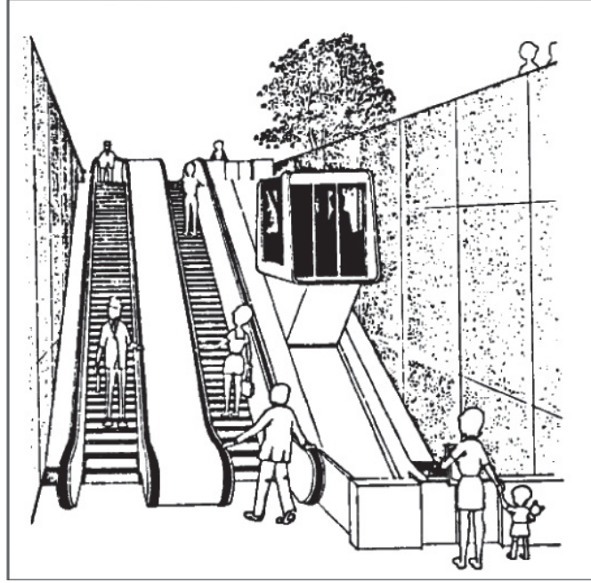
Şekil 3.29. Merdiven eğiminde eğik asansör (TS 12576 Şekil 19a)
