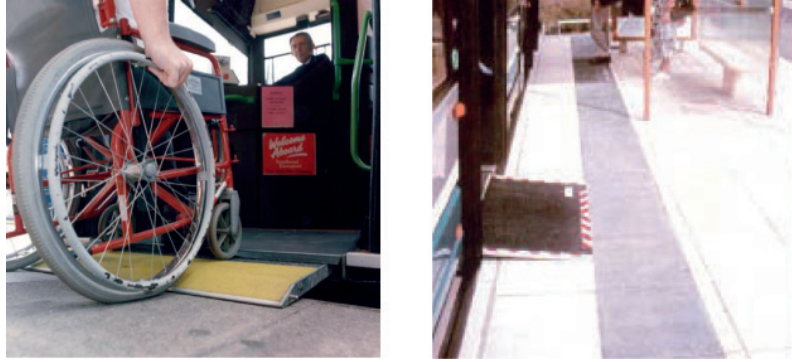
Fotoğraf 3.4. Basit (el kontrollü) rampa uygulama örneği (ÖZİDA, 2008)
